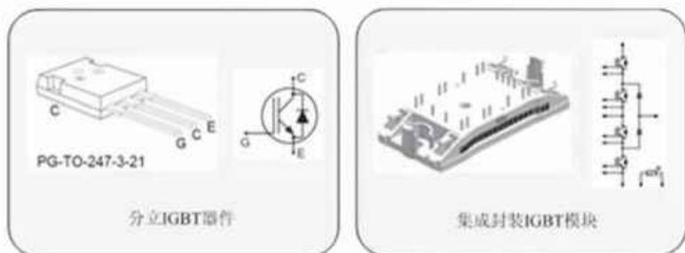
块具有极大的电流通断能力，不需并联即可满足功率模块的需求，同时集成了续流二极管，降低了设计工艺与生产过程的风险。通过采用集成封装的IGBT模块，RM-P系列产品在实现高效率、低功耗的同时，保证了功率模块以及系统的高可靠性。
